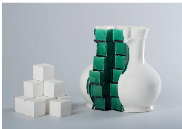
Figura 02 – Produto cerâmico obtido pela conjugação do processo referido na Figura 1 com a reutilização de moldes em fim de vida de produtos industriais.
