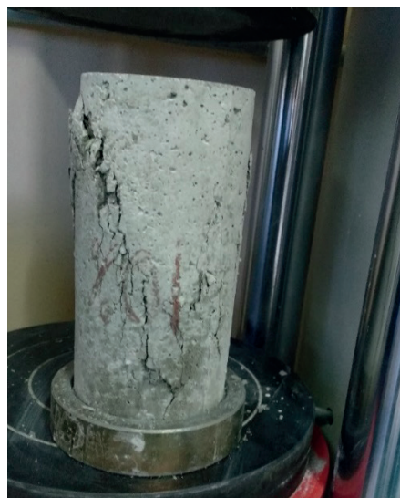
Figura 01 – Concreto com adição 30% de PET.
