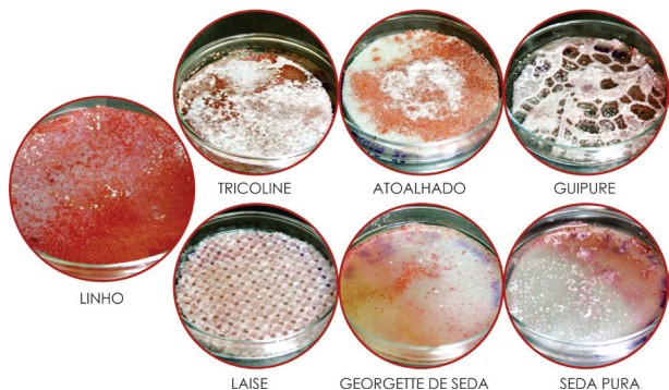
Figura 12: Tingimentos em diferentes tecidos pigmentados com o isolado G27.
